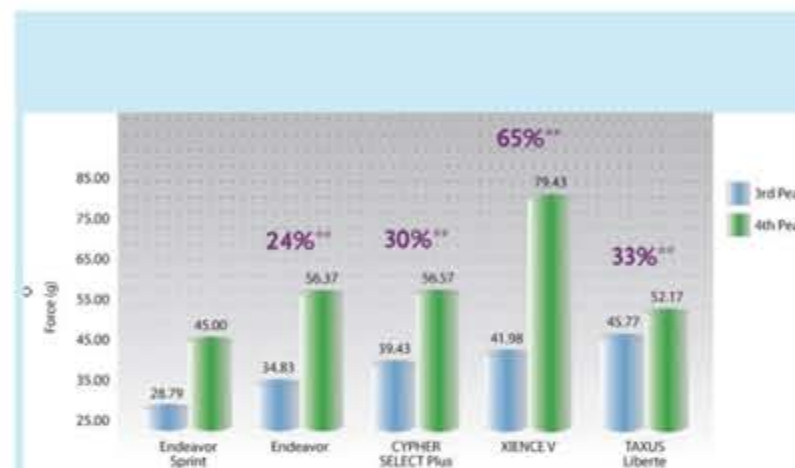
图 1 不同药物洗脱支架通过三维扭曲血管模型的体外试验。Force 代表所使用的力, 3rd peak 和 4th peak 分别代表通过第 3 个弯曲和第 4 个弯曲所需要的外力, 外力越小说明支架的柔顺性越高和到达病变的能力越强, ** 代表与不同的支架比较, Endeavor Sprint 支架到达病变能力的改善程度。试验中采用 Endeavor, Cypher Select, Xience V 支架为 3.5mm×18mm, TAXUS Liberte 支架为 3.5mm×20mm。
